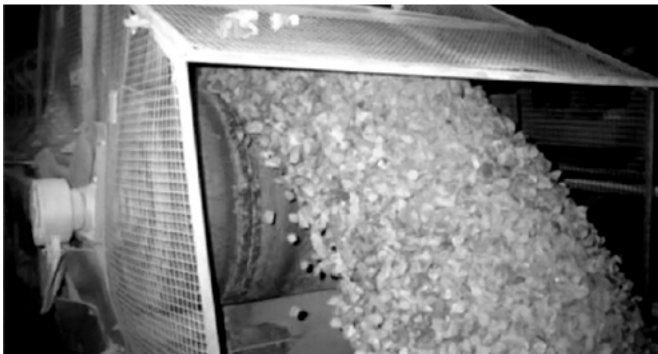
Специальное решение, 2 мотор-барабана в одном транспортере - 2 x 800М, 37.0 кВт, работают в реверсивном режиме.
